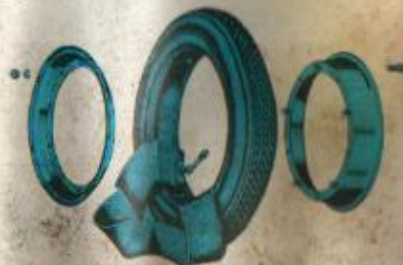
Fig. 30 Desmontaje del neumático.
