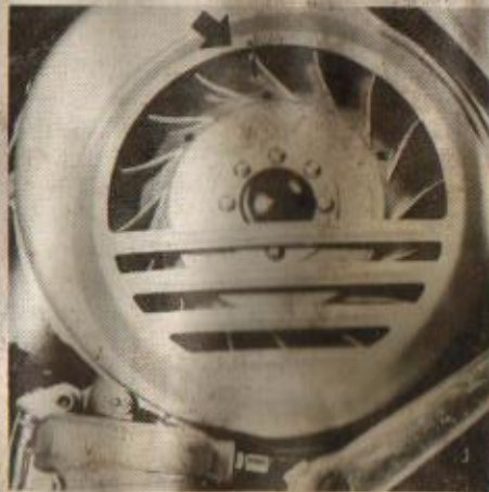
Fig. 42 Marcas de referencia en el rotor y tapa de caracol.
